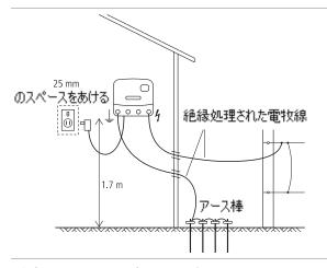
*注意*:屋内取り付けでも、必要に応じてコンセントの電源に代わりバッテリーを利用できます。
