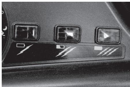
3段階のLEDライトのうちの一つが通電パルスごとに点滅し、出力電圧の状況をお知らせします（バッテリー残量表示にしている場合を除きます）。
